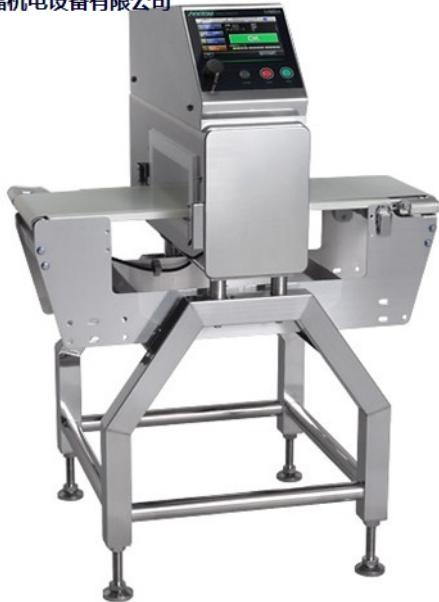
在生活中, 食品安全事件层出不穷, 如在食品中吃出铁丝、螺丝钉等等。那么要如何检测出混入产品中的金属呢? 这就不得不提到金属检测机了。随着对食品安全的重视, 几乎所有的大型食品生产厂家都安装了金属检测机, 利用电磁感应的原理, 对食品进行检测来衡量金属含量是否超标。要想把产品输送到指定的检测位置, 那就需要使用到输送带。金属检测机上使用的输送带是怎么样的呢? 接下来, 小编就给大家普及一下。金属检测机上使用的输送带具有以下几个特点: 1、输送带带体弹性好、不易变形。2、输送带具有良好的耐化学腐蚀性, 优良的电绝缘性, 不易燃性。3、输送带强度高、耐气候变化性, 有优良的几何稳定性。4、输送带对氧化剂、还原剂、强酸都有很强的抵抗力。5、输送带无毒无污染, 符合卫生指标。金属检测机上使用的输送带的颜色一般以白色、绿色居多。上述所说的输送带只是金属检测机上使用的输送带中的其中之一种, 根据不同的检测机, 不同的工作环境, 输送不同产品的特性, 其所使用的输送带也是不相同的。河南日本原装安立金属检测机厂家典型的金属检测系统由下列四种主要部件构成。
