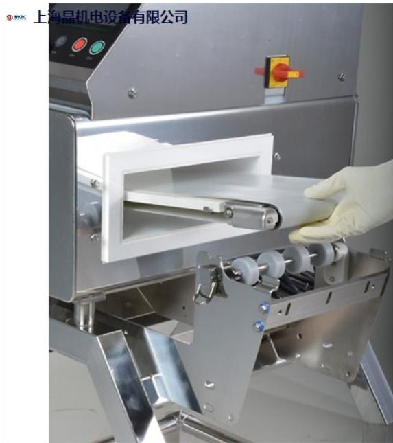
食品生产中的金属探测仪操作方法：灵敏度的设定根据相关法规的要求以及设备的能力来确定金属检测器的灵敏度，生产车间的金属检测器灵敏度设置有密码控制，只有授权人员才能检查调整。灵敏度的一般要求：金属污染物检测质量控制环节的精度，受检测产品，金属污染质量关键点控制方案设计影响。如：（1）烘焙行业的小蛋糕，金属污染质量关键点控制在产品内包完成后，选用的金属探测器精度是：铁0.8mm□不锈钢2.0mm□□2□糖果行业的巧克力制品，金属污染质量关键点控制在产品内包完成后，选用的金属探测器精度是：铁1.2mm□非铁2.0mm□不锈钢2.5mm□□3□烘焙行业的曲奇产品，金属污染质量关键点控制在产品内包完成后，选用的金属探测器精度是：铁1.5mm□非铁1.5mm□不锈钢2.0mm□□4□海产品冷冻粗加工的冷冻海鲜，金属污染质量关键点控制在产品冷冻内包完成后，选用的金属探测器精度是：铁1.5mm□不锈钢3.0mm□
